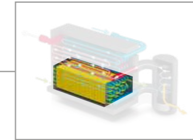
Scambiatore di calore aria/refrigerante con massa termica (parte in giallo)
